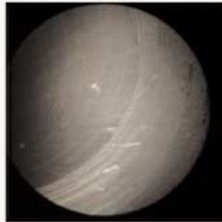
Mit der VFG Reinigungspaste und drei ölgetränkten Intensivfilzen konnten diese Ablagerungen gut entfernt werden.
